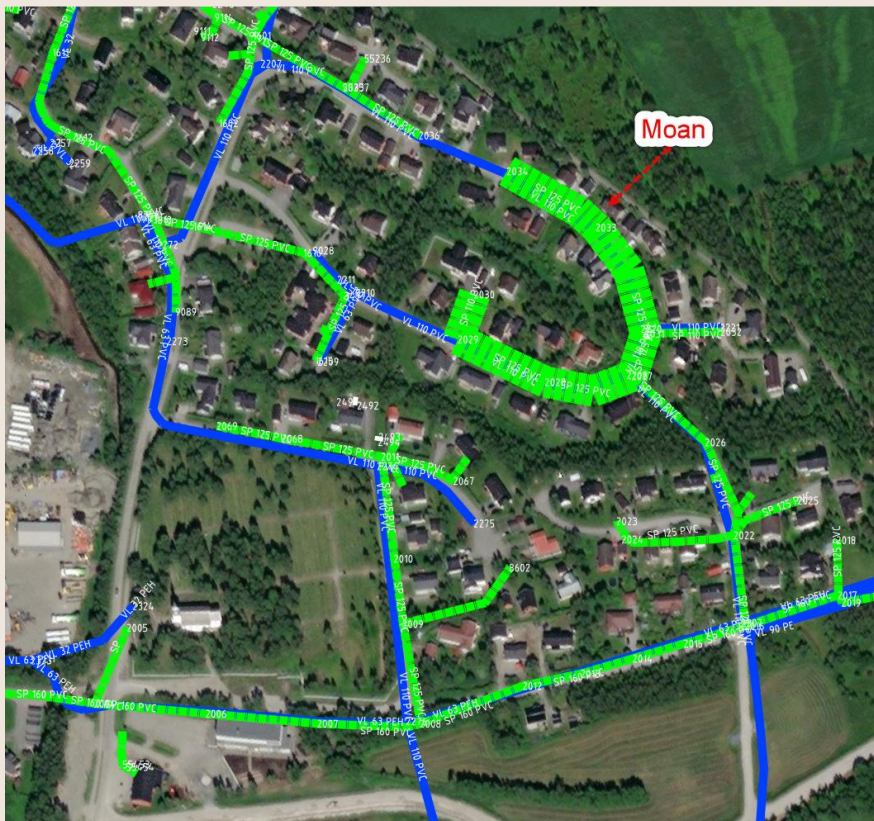
Figur 18 Moan – dårlig fall og tilstopninger på lednignsnettet
